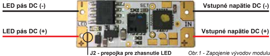
Obr.1 - Zapojenie vývodov modulu
